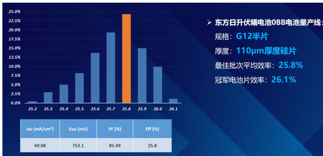
图 2.4 东方日升超薄硅片异质结电池的转换效率
